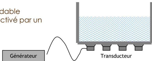
▫ Sous l'effet du signal émis par le générateur, le transducteur crée une **onde sonore** qui se propage dans le liquide
