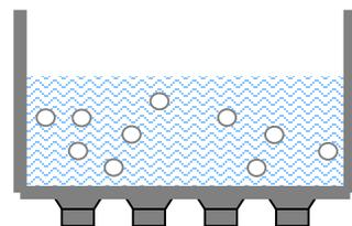
▫ Lors des phases de pression, les bulles de vide implosent au contact des pièces immergées permettant ainsi le décollement des saissures.
