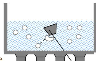
De plus, lors de cette implosion, ces bulles restituent leur énergie créatrice, énergie qui accroît l'efficacité de l'action chimique de la solution de nettoyage.
